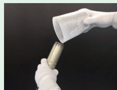
ヘラ乗りが悪い時は注入ポンプへ直接流し入れる様に充填します。
