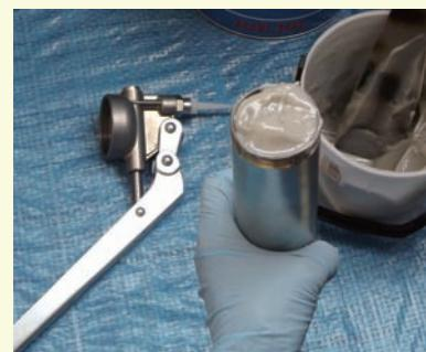
注入ポンプに充填し、注入します。
