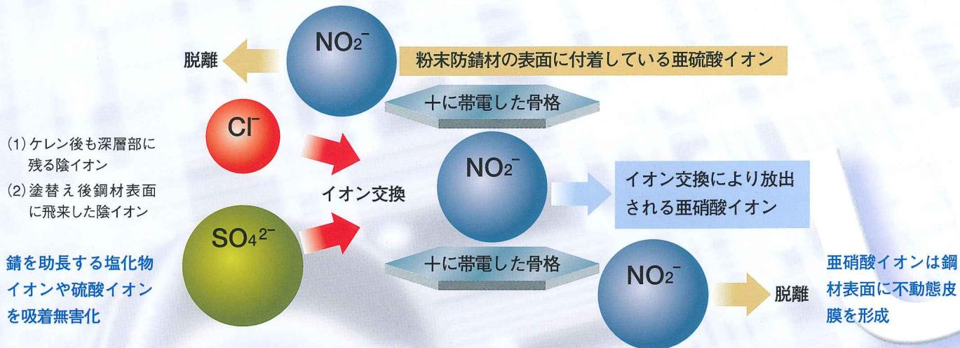
粉末防錆材は層状のカルシウム・アルミニウム複合水酸化物で、層間や周囲に大量の亜硝酸イオン( $\text{NO}_2^-$ )を担持しています。腐食に有害な陰イオンとのイオン交換や、水と出会うことにより $\text{NO}_2^-$ は放出され、鋼材表面に不動態皮膜を形成し、極めて良好な防錆環境を作り出します。
